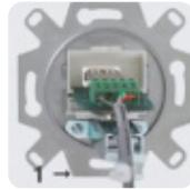
**4.** Fije el cable al soporte (1) con una brida y conecte los cables y blindaje siguiendo el código de colores de la tabla.
